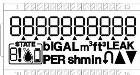
Der LCD-Bildschirm ändert sich automatisch, um die folgenden Informationen anzuzeigen: Netto- oder Vorwärtsvolumen, Rückwärtsvolumen, Durchflussrate, Ereignisse, Firmwareversion, Durchflussrichtung, Zählerzustand. Die grundlegende Anzeigesequenz wird in zwei Zyklen definiert, einem Hauptzyklus und einem Sekundärzyklus, der nach 120 Sekunden startet.
